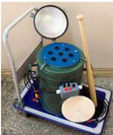
При градуировке, калибровке или поверке ТС рекомендуется проводить измерения в реперной точке в нулевом термостате при 0 °С или в высокостабильном жидкостном термостате (нестабильность не более  $\pm 0,002$  °С). Для создания реперной точки 0 °С рекомендуем использовать термостаты нулевые "Лёд-Сибирь", производства ООО "КТС-сервис".
